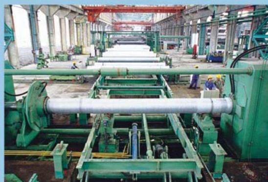
水压试验 Hydraulic pressure testing
