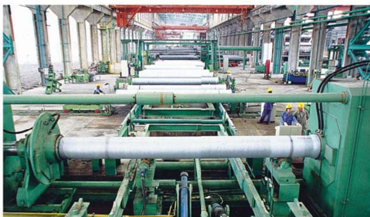
水压试验 Hydraulic pressure test
